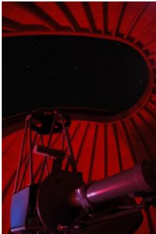
65 cm teleskop za opažanje zvijezda sastoji se od primarnog zrcala promjera od 650 mm u Cassegrainovoj izvedbi te sekundarnog zrcala promjera od 300 mm, a upotrebljava se žarišni omjer f/11.2. Opremljen je fotometrom koji sadrži okular s nitnim križom, izmjenive dijafragme i filtre (posebno za UVB sustav), fotomultiplikatorom i brojačem.
